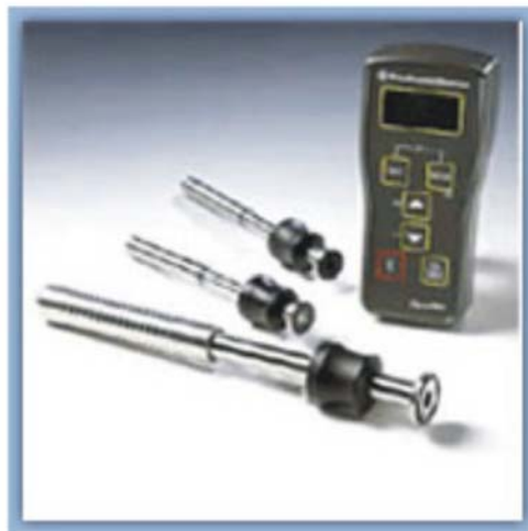
15. ábra. Dinamikus keménységvizsgáló eszköz digitális kijelzéssel
