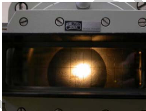
3. ábra. A lenyomat mérése Brinell keménységmérésnél
