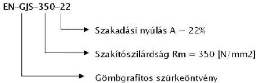
24. ábra. Gömbgrafitos öntöttvasak szabványos jelölése
