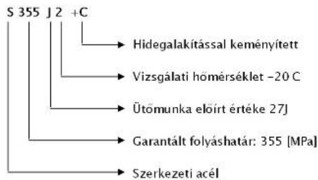
17. ábra. Az acélok szállítási állapotára utaló jelölések
