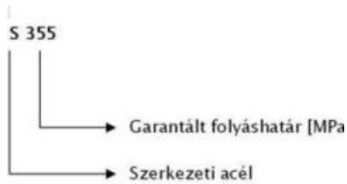
13. ábra. Szerkezeti acélok jelölése
